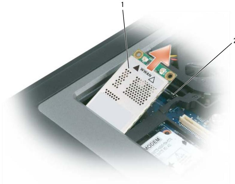
1 placa de rede móvel de banda larga 2 presilhas metálicas de fixação (2)
