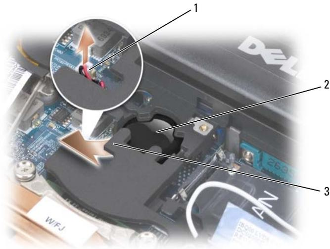
1 conector da bateria      2 bateria de célula tipo moeda      3 mylar
