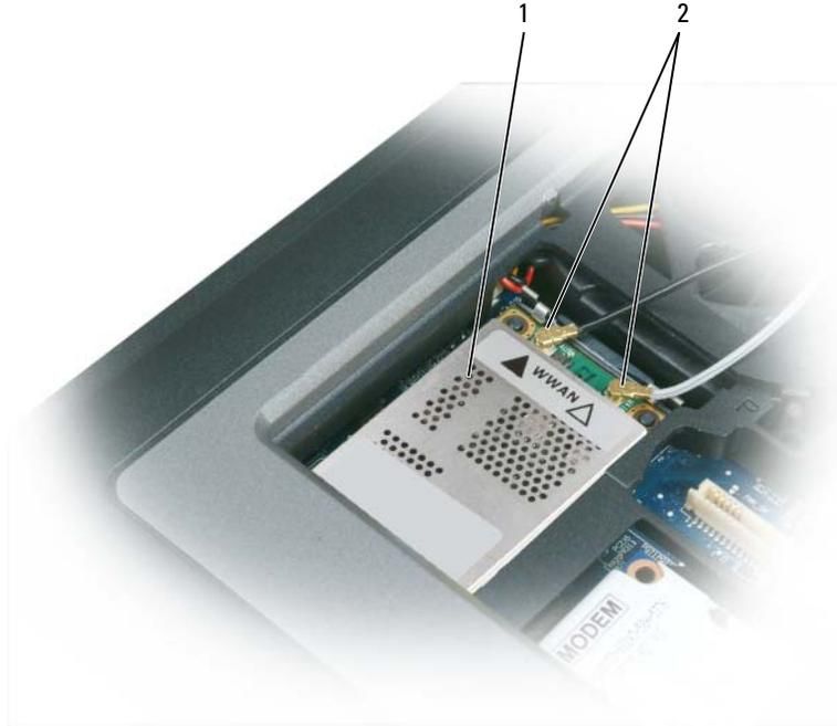
1 placa de rede móvel de banda larga    2 cabos da antena (2)
