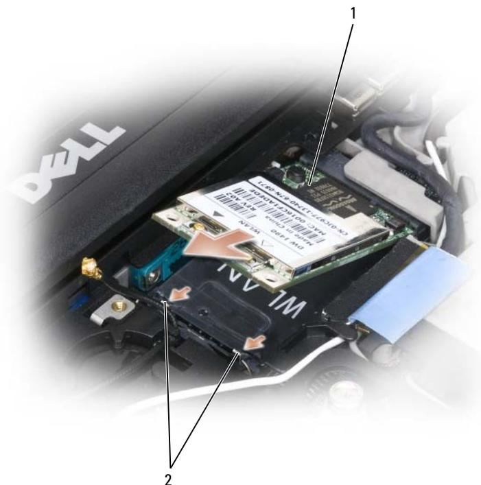
1 placa WLAN                      2 presilhas metálicas de fixação (2)
